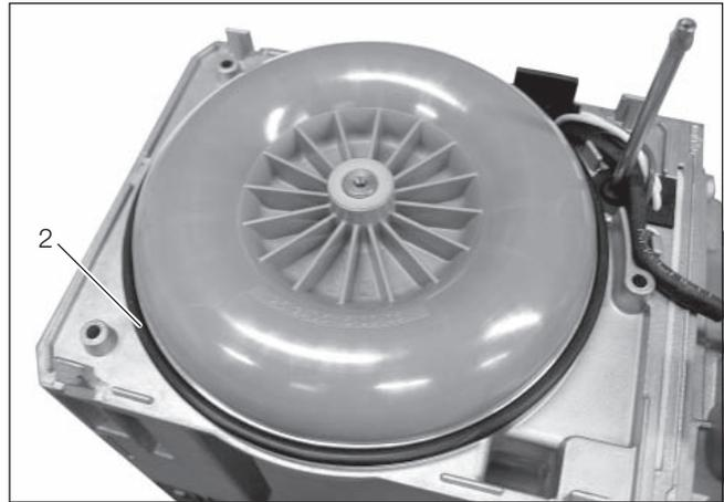
2 O-Ring, an der Steuergerät / Gebläseeinheit angelegt
