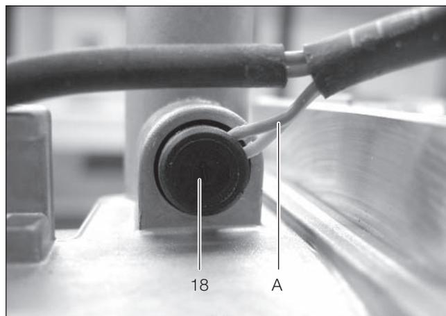
A Korrekte Einbaulage und Kabelführung
